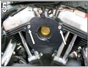
mitgelieferte Inbusschrauben (1/4") durch vorgesehene Bohrungen in der Grundplatte in Drosselklappe einschrauben
